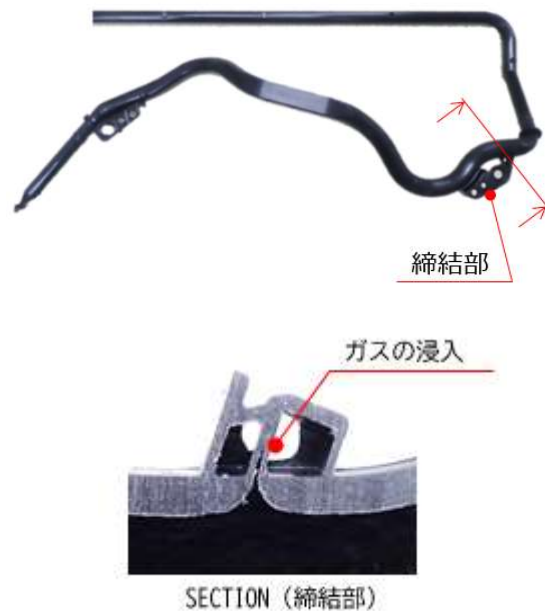
図-6 製品締結部の不具合状態
